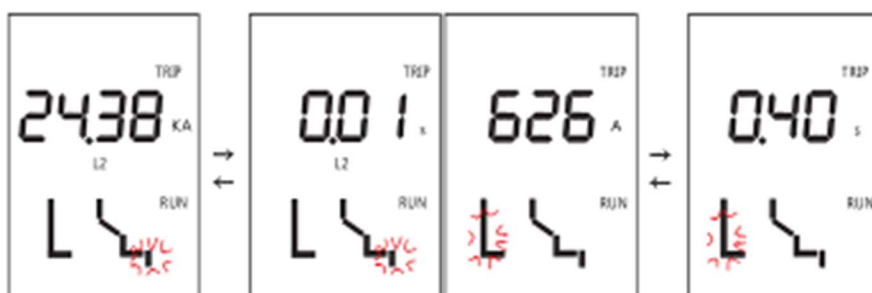
Рисунок 76-а. Состояние мгновенного расцепления при неисправности
