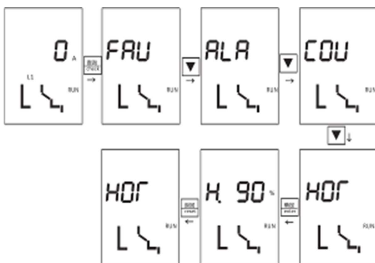
Рисунок 74. Просмотр данных по накоплению тепла при размыкании автоматического выключателя из-за неисправности
